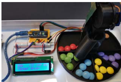
Rechts: Farberkennung mit 2 Servo-Motoren über einen Arduino Nano und ein LCD-Display
